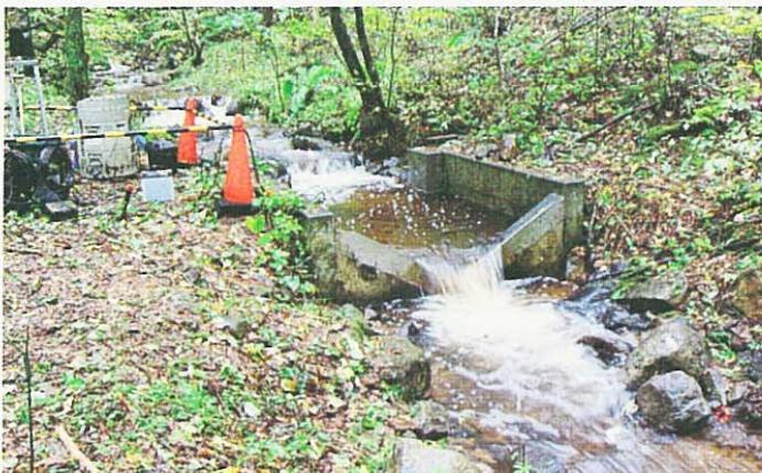
尾坂兼一研究員らは塩川上流の渓流に設置されているせきを使って、森林の土壤から流れ出す栄養塩の量を調べています
