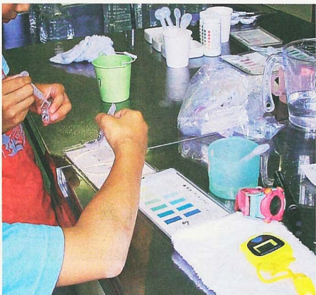
水中の汚れの量を色で判断するバックテスト
