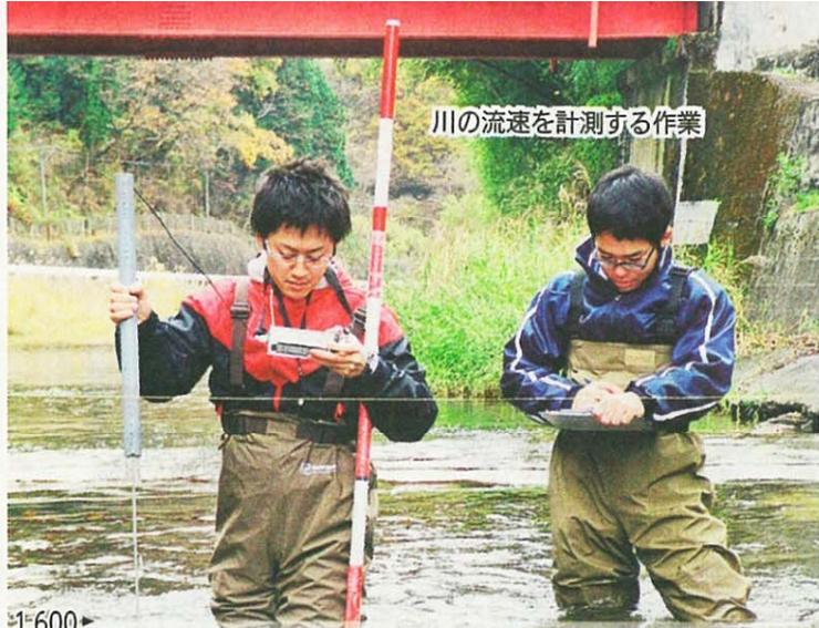
川の流速を計測する作業
