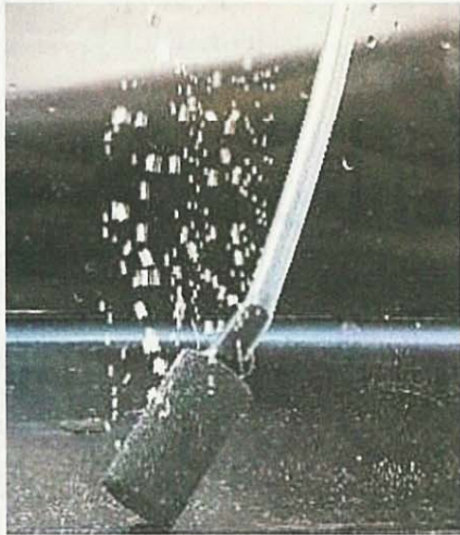
エアストーンから吹き出ている泡。大きさを 違う泡が出ていますが、マイクロバブルはこ れよりはるかに小さな泡です
